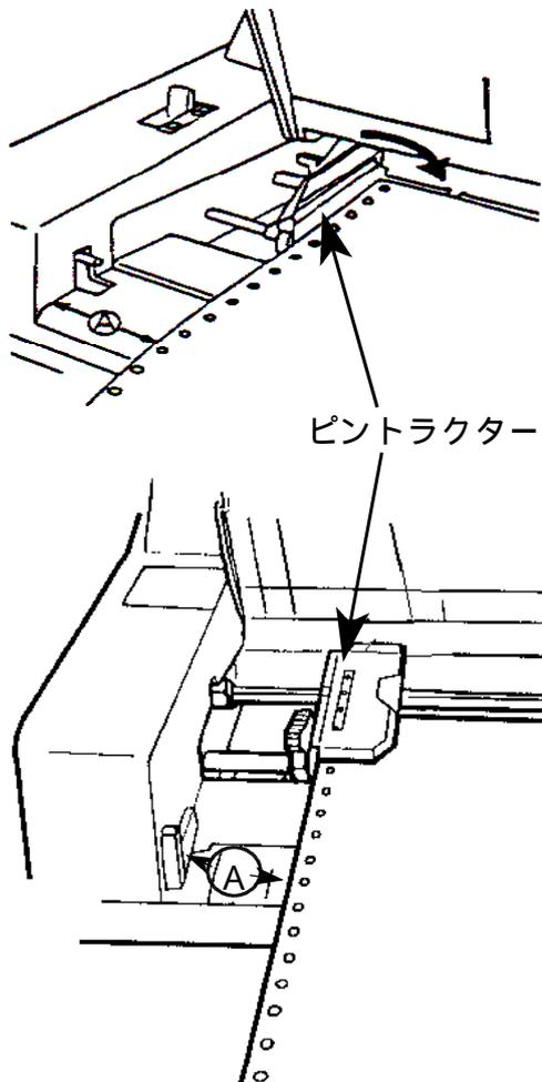
左側のピントラクターを固定します。
