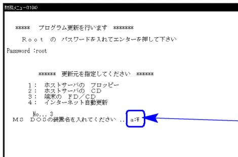
3: 端末のFD/CDを選択すると『MS-DOSの装置名を入れてください..a:¥』と表示されますので、CD-ROMのドライブ名を入力します。
