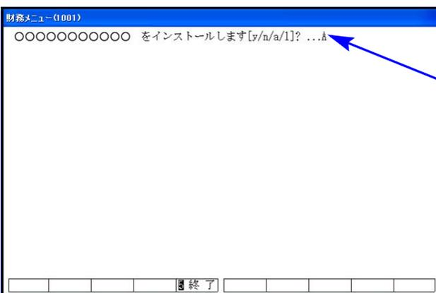
④ インストールを実行します。左図の1行目の画面を表示します。『○○○をインストールします[y/n/a/1]?...』 a 又は 1 を選択します。
